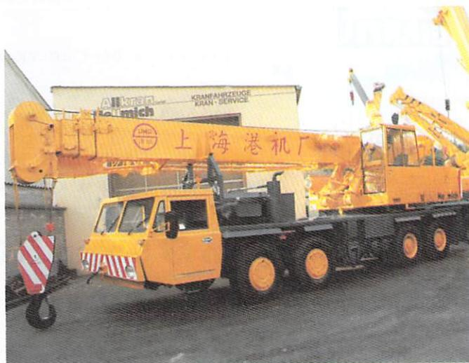
为上海港口机械制造厂提供的可伸缩的汽车起重机，载重量 50 吨。
