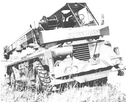
Kranbewegungen können von dieser Kabine aus auch alle Fahrbewegungen einschließlich Betätigung der Bremsen und Lenkung gesteuert und zusätzlich die Abstützungen betätigt werden.
