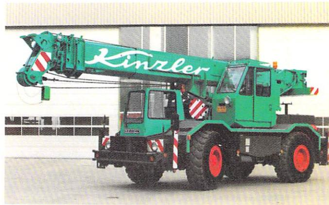
Teleskop-Geländekrane 20 km/h und 70 km/h
