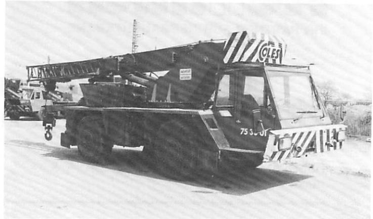
Tragwerte in Mp = DIN 15.019.2, 360° Schwenkbereich
